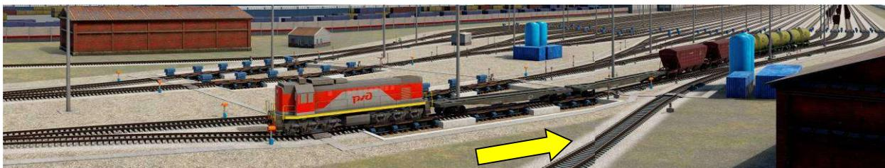
**Рисунок 10.18. 3D-визуализация осаживания состава с горба горки**
