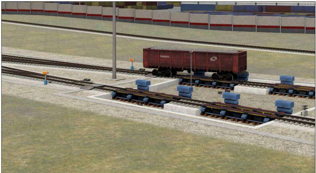
Рисунок 8.9. Имитация схода вагона при взрезе стрелочного перевода
