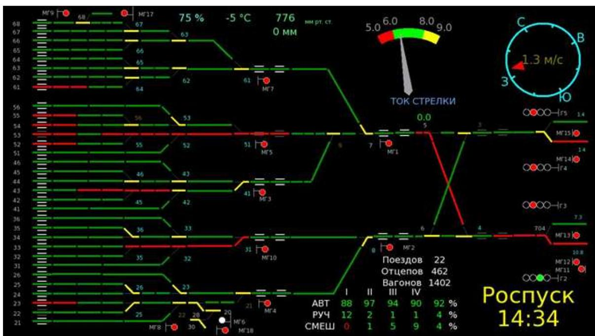
Рисунок 1.7. Отображение имитации горочного табло коллективного пользования (ГТКП, экран 1)
