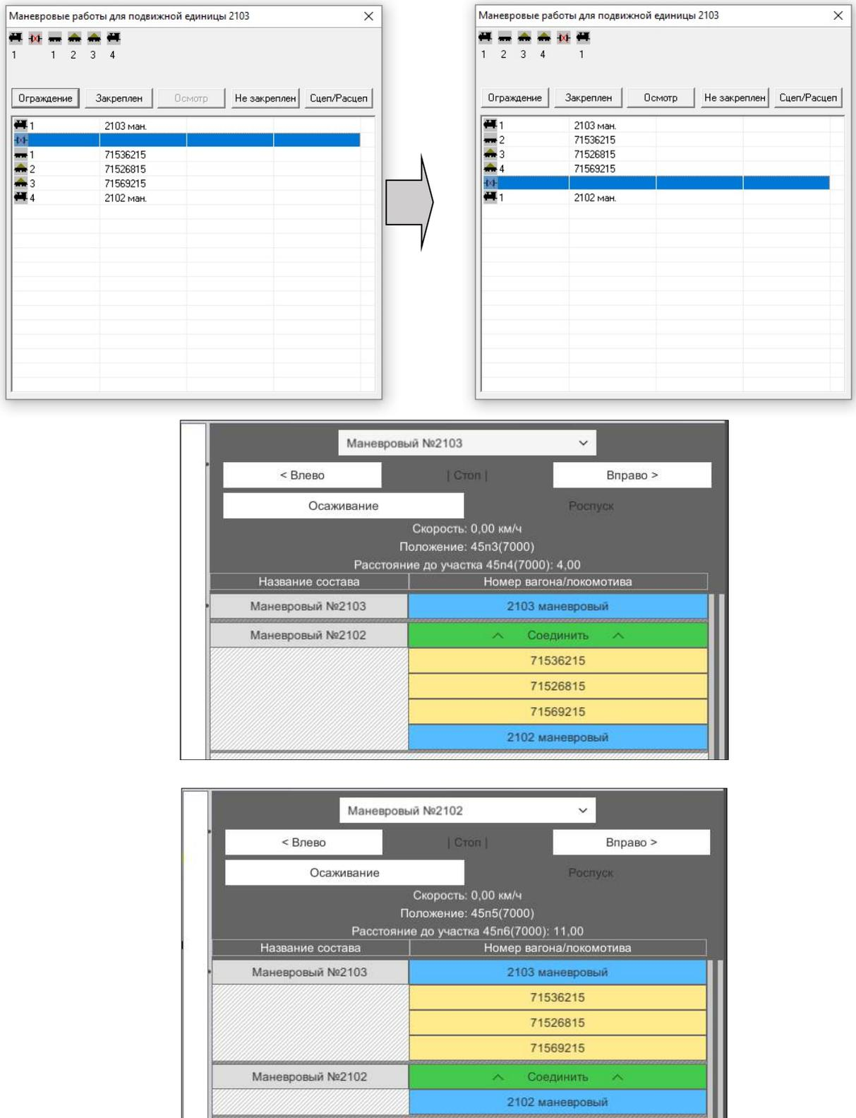
**Рисунок 10.24. Процесс прицепки второго локомотива и отцепки первого локомотива от снятой с горба горки группы вагонов**
