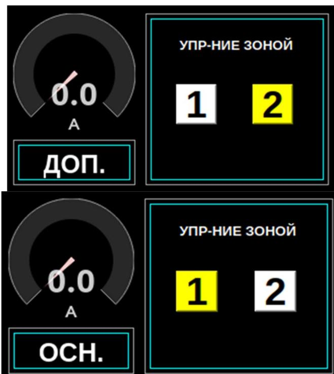
**Рисунок 5.7. Отображение индикации завершения процесса передачи второй зоны с основного пульта на дополнительный**
