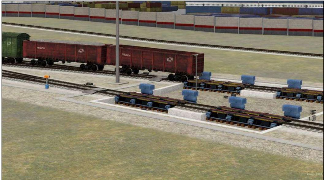
**Рисунок 8.6. Имитация схода в результате его входа на включенный замедлитель**
