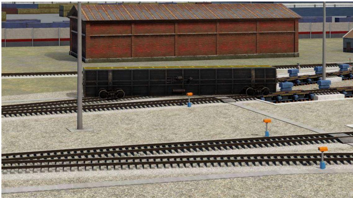
**Рисунок 8.12. Имитация схода длиннобазного вагона в результате перевода стрелки между тележками вагона**
