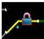
**Рисунок 3.21. Отображение заблокированной для автоматического перевода стрелки**
