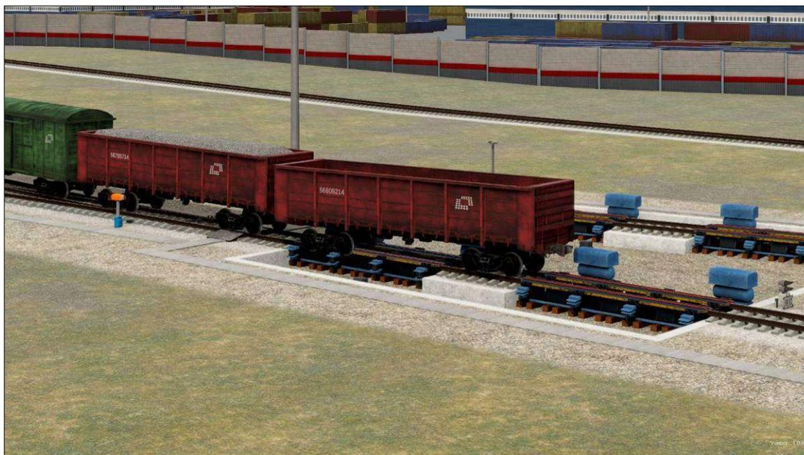
**Рисунок 8.3. Имитация схода вагона в отцепе легкой весовой категории в результате его выдавливания на замедлителе**
