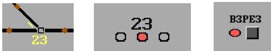
**Рисунок 7.5. Отображение потери контроля стрелки на вспомогательном пульте**
