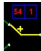
Рисунок 3.26. Отображение отцепа, имеющего вагон с особым признаком, или требующего роспуска с особыми условиями
