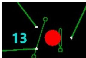
**Рисунок 3.15. Отображение индикации потери контроля стрелки**
