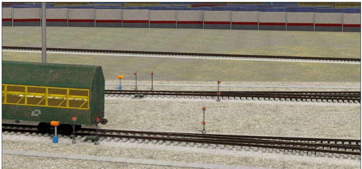
**Рисунок 8.7. Имитация схода вагона на потерявшей контроль стрелке**
