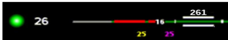
**Рисунок 3.56. Отображение БЗУ в заторможенном состоянии**
