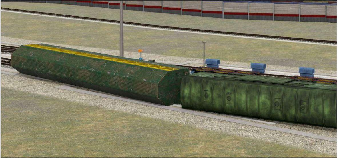
**Рисунок 8.14. Имитация схода вагонов с опрокидыванием в результате столкновения отцепов на относительной скорости более 25 км/ч или при необеспечении габаритности стрелочного участка**
